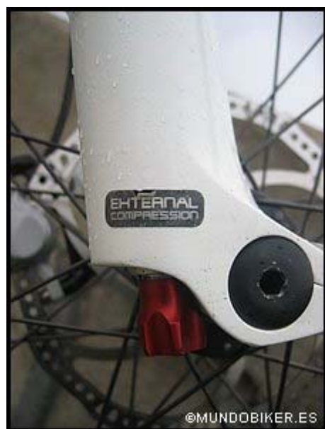
Ajuste de compresión a baja velocidad, dial rojo, de una horquilla Marzocchi 888 RC2X
