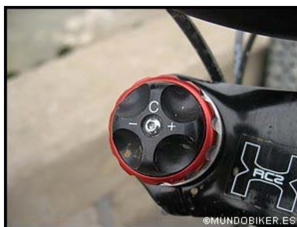
Ajuste de compresión a alta velocidad, dial negro C, (final de recorrido) de una horquilla Marzocchi 888 RC2X
